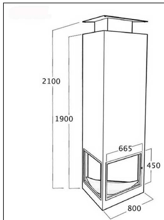
Magnifique cheminée triangulaire centrale suspendue, avec une vision du feu sur 360°; entièrement conçue en acier corten. Cheminée axiale avec un parfait design doté d'une excellente répartition de la chaleur. Large foyer permettant d'insérer de grandes bûches de bois.
