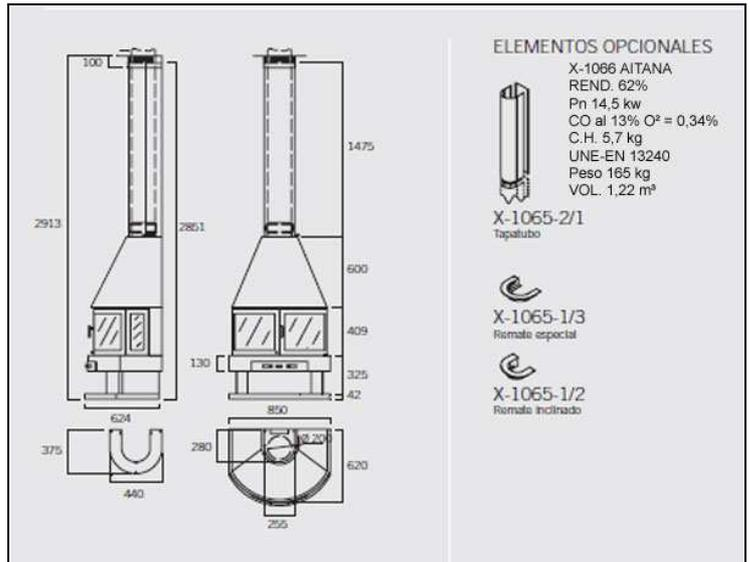
Superbe cheminée demi-ronde avec deux portes vitrées en vitrocéramique construite en acier corten pour une meilleure diffusion et conservation de la chaleur, briques réfractaires dans le fond du foyer. La cheminée face 1 avec un design très fluide, Une grande capacité de chauffe équipée d'un grand bac à cendre, une clé de registre pour permettre un feu continu pour toute la nuit et d'un range bûche. Peinture cuite au four, couleur au choix noir anthracite ou gris métal
