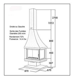
Belle cheminée campagnarde d'angle fonctionnant au bois, avec porte en vitrocéramique, sa hotte en forme "pagode" et ou au choix foyer ouvert ou fermé, cheminée réalisée en acier corten avec foyer en briques réfractaires. Finition avec poignée laiton et entourage vitres. Equipée d'une clé de registre permettant de régler la combustion du bois. Grand foyer avec range bûches. Grosse puissance de chauffe. Réalisée côté droit ou gauche.
