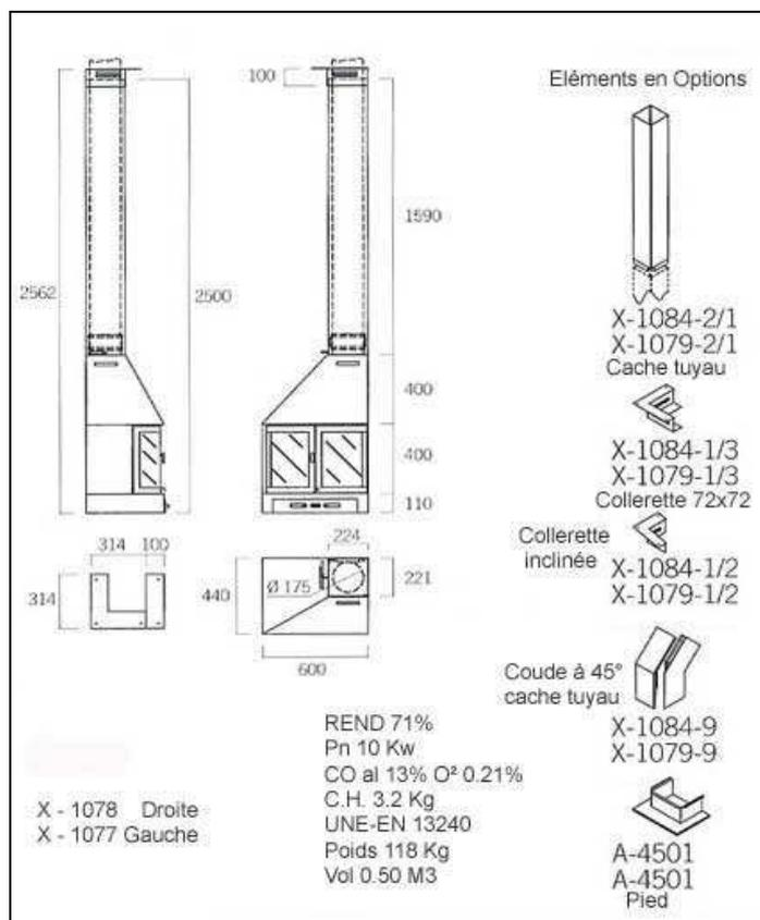
Cheminée d'angle avec 2 portes en vitrocéramique, conçue en acier corten avec foyer en fonte. La cheminée angle 8 vous offre une superbe vision du feu avec une finition noir anthracite ou gris métal au choix, cheminée équipée d'une clé de registre permettant de contrôler la combustion du bois afin de conserver un feu continu la nuit. Cette cheminée angulaire peut être suspendue ou posée au sol avec un pied en option. Grand bac à cendres. Bénéficie du crédit d'impôt
